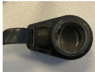
**Figure 3.** AR module attachable to loupes.
